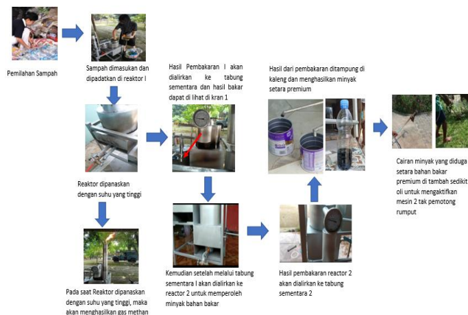
Gambar 5. Tahapan Kerja dari Mesin Pirolisis
