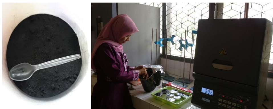
Gambar 1. Aktifasi Arang Cangkang Sawit dengan menggunakan alat furnace
