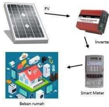
Gambar 1. Ilustrasi arsitektur pemanfaatan Photovoltaic untuk beban rumahan
