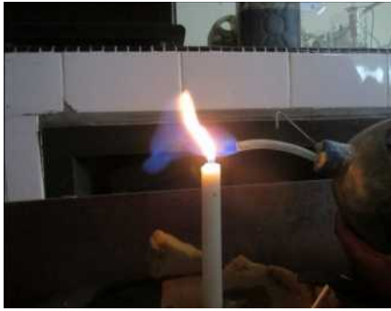
Gambar 3. Hasil pembakaran biogas. Uji positif mengandung gas metan (nyala api berwarna biru).
