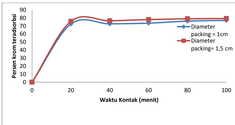
**Gambar 2.** Grafik hubungan persen (%) krom teradsorpsi dengan waktu kontak untuk laju alir 240 ml/menit
