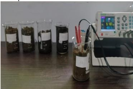
Gambar 3. Pengukuran nilai impedansi sampel
