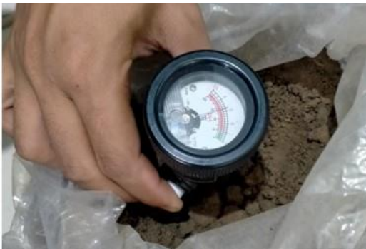
Gambar 2. Pengukuran kelembaban pada sampel
