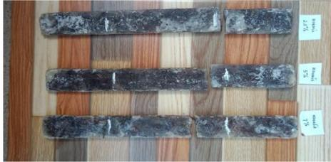
**Gambar 2.** Hasil Patahan Pengujian Tarik Komposit Serat Batang Kelakai
