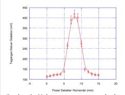
Gambar 3. Hubungan antara posisi berkas (mm) dengan Keluaran Detektor (mV) arah horizontal
