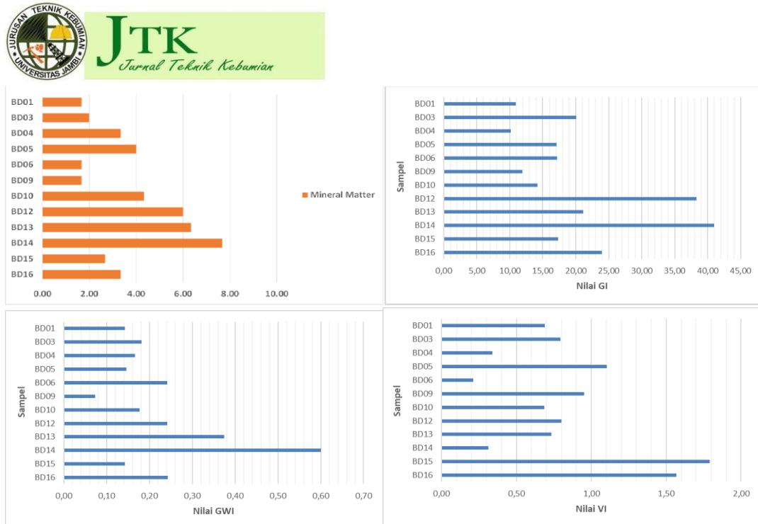
Gambar 8. (kiri atas) Kecenderungan (Trend) Mineral Matter dari Top ke Bottom. Gambar 9. (kanan atas) Kecenderungan (Trend) Nilai GI dari Top ke Bottom. Gambar 10. (kiri bawah) Kecenderungan (Trend) Nilai GWI dari Top ke Bottom. Gambar 11. (kanan bawah) Kecenderungan (Trend) Nilai VI dari Top ke Bottom.
